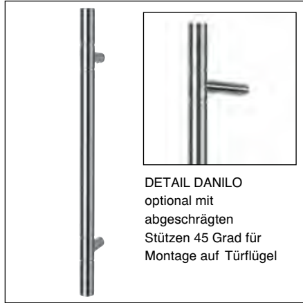
DANILO, Edelstahl, mit vier polierten Ringen DANILO 45 , mit 45° Stützen (Griffmontage auf Türflügel) H 600 mm Art.-Nr.1576 • PG 275 DANILO 90 , (Griffmontage auf Haustürfüllung) H 600 mm Art.-Nr.1575 • PG 300
